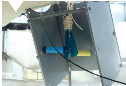
Ici, il s'agit de la mesure gravimétrique des particules qui nécessite aussi une pompe plus importante et plus sonore. Comme la source principale des particules fines est le trafic routier, il est important de les mesurer à l'extérieur et à l'intérieur afin de vérifier, par exemple, la performance des systèmes de filtration de l'air extérieur.
