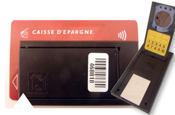
garde les traces des impacts des particules alpha-radioactives. La durée de pause est de deux mois. « Si le bâtiment se trouve dans une zone à potentiel radon élevé, nous n'hésitons pas à inspecter plusieurs pièces », insiste Suzanne Déoux.
