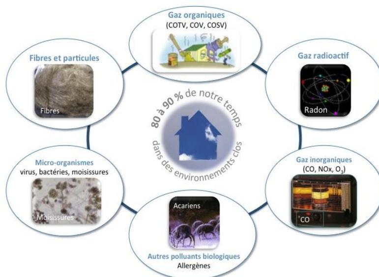
Figure 2 : Divers types de polluants dans l'environnement intérieur. Sigles : COTV : Composés organiques très volatils, COV : Composés organiques volatils, COSV : Composés organiques semi-volatils, CO : monoxyde de carbone, NOx : oxydes d'azote, O<sub>3</sub> : ozone . Source : Support formation MEDIECO, 2014.
